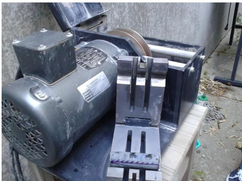
Figura 7 - Lâmina dupla e suporte para o cilindro. Notar as marcas neste.
