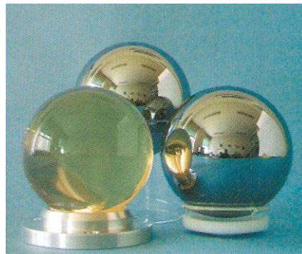
Figura XIII. 4- Cristal de Silício (e duas esferas de prata de igual volume) com número de átomos e volume bem determinados, candidato a protótipos do quilograma padrão.
