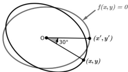
$$\begin{bmatrix} x' \\ y' \end{bmatrix} = \begin{bmatrix} \cos(30) & -\sin(30) \\ \sin(30) & \cos(30) \end{bmatrix} \begin{bmatrix} x \\ y \end{bmatrix} = \begin{bmatrix} \frac{\sqrt{3}}{2} & -\frac{1}{2} \\ \frac{1}{2} & \frac{\sqrt{3}}{2} \end{bmatrix} \begin{bmatrix} x \\ y \end{bmatrix},$$
